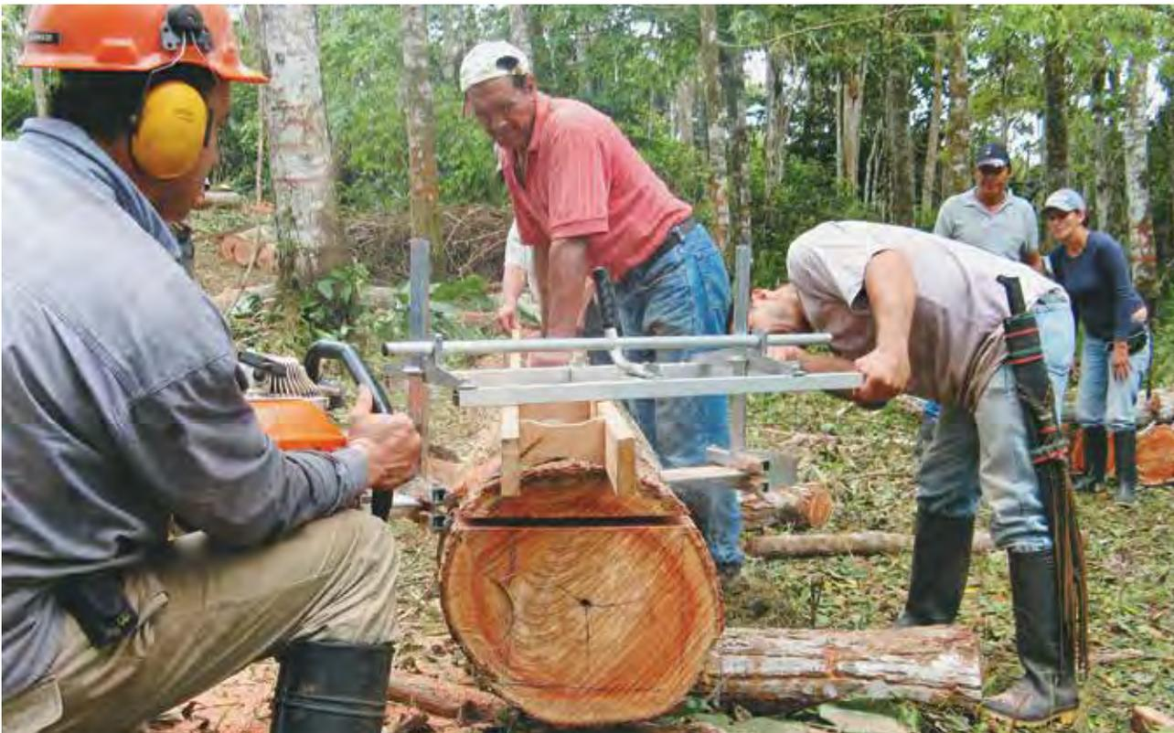
**Figura 25.** Fotografía. Obtención de bloques de madera comercial de un árbol de abarco de 25 años, aprovechado en la Estación Experimental El Trueno, Guaviare, Colombia
