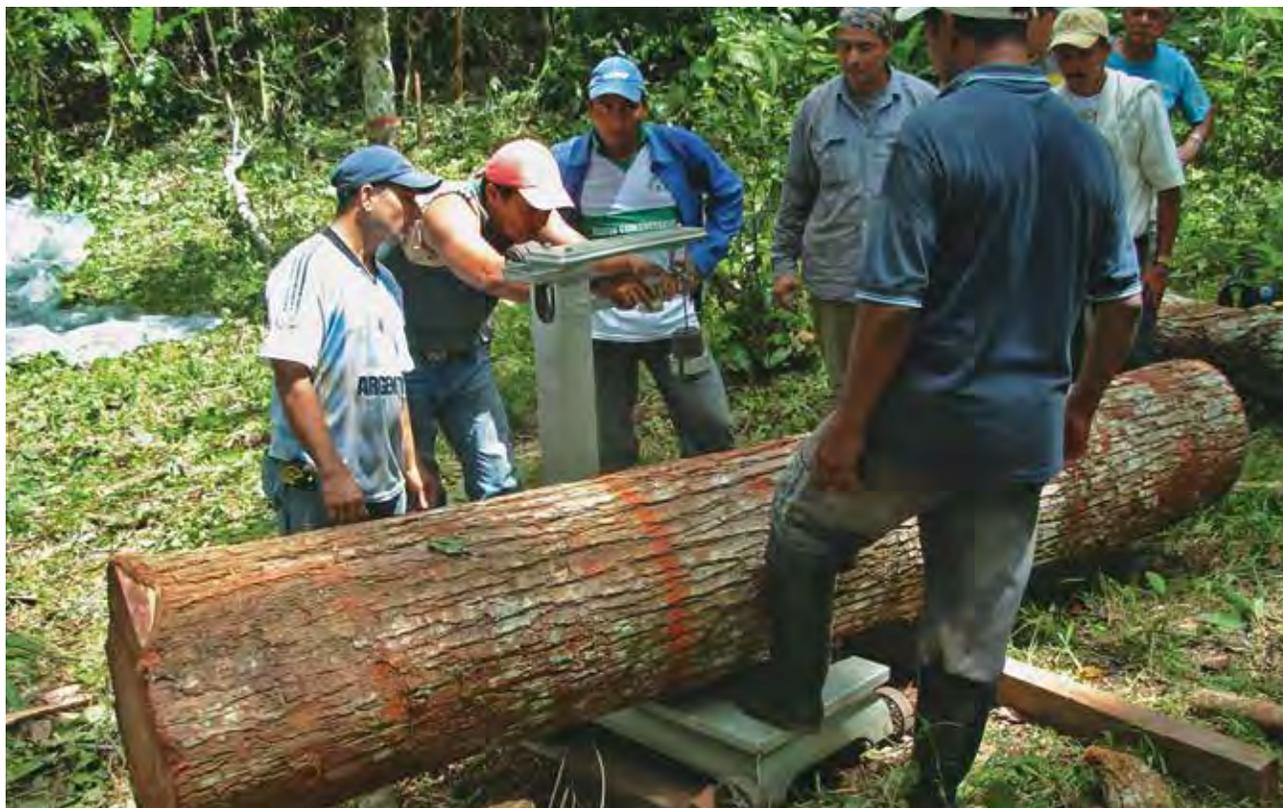
**Figura 23** Fotografía. Pesaje de fustes y de diferentes muestras de especies forestales, establecidas en la Estación Experimental El Trueno, Guaviare, Colombia
